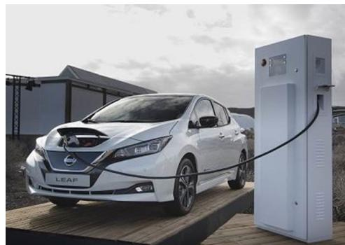
L’obiettivo del progetto aggiudicatario è sperimentare su vasta scala 1.000 installazioni Vehicle-to-Grid per definire i parametri di una applicazione commerciale destinata ai clienti di flotte elettriche. I caricatori saranno gestiti da un aggregatore e i dati raccolti serviranno a capire le specifiche tecniche della ricarica bidirezionale sia dal lato dei veicoli che da quello delle reti elettriche.
